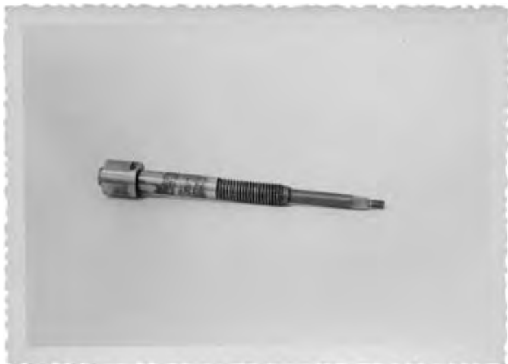
Soplante nº 1. Eje de la válvula auxiliar de entrada de vapor. Manuel Rodríguez Velo. 14 de enero, 1957. 8x12 cm. Gelatina de plata. Fundació de la C.V. de Patrimoni Industrial de Sagunt.
